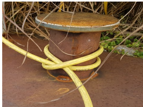
Kabel ist mit einem Schlag am Poller befestigt
